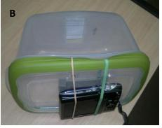
**Figura 13.** Dispositivo artesanal utilizado para la fotografía de muestras foliares al inicio y final del experimento. (A) vista superior. (B) vista lateral (Foto del autor)
