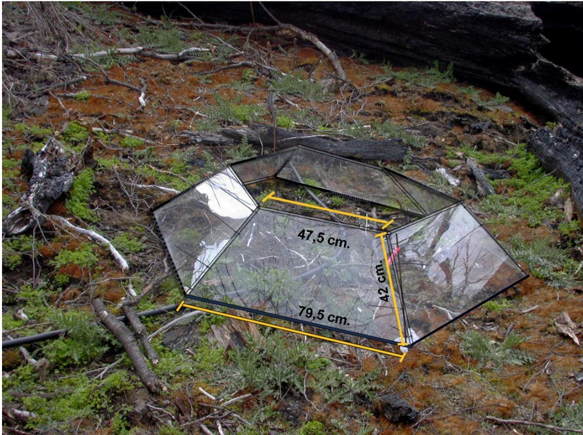
Figura 1: Imagen con dimensiones de una de las 64 cámaras hexagonales de techo abierto (OTCs) usadas para incrementar la temperatura en los experimentos de campo colocada en un bosque incendiado de *Nothofagus pumilio*. Nótese el conducto de riego que alimenta un microaspersor central a la parcela.
