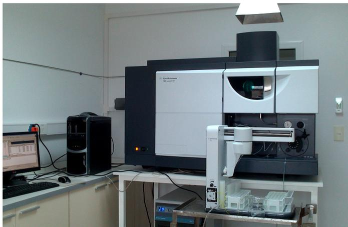
Figura A.2: Espectrofotómetro de plasma de acoplamiento inductivo (ICP-OES), Modelo Agilent 720.
