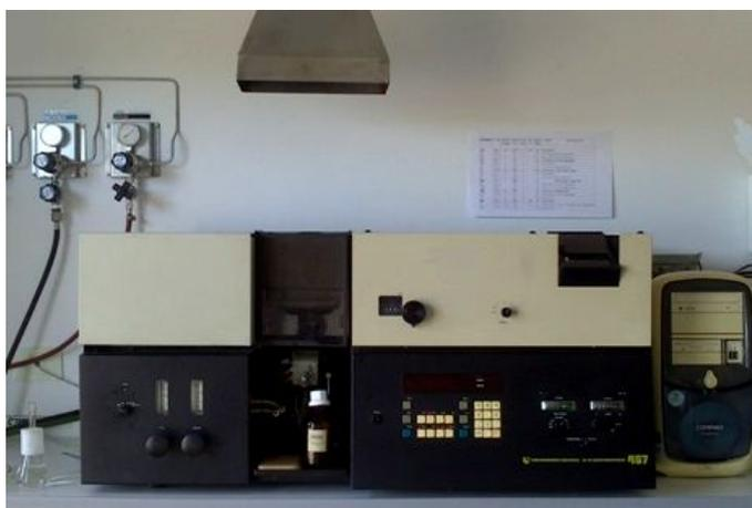
Figura A.1: Espectrofotómetro de absorción atómica IL457
