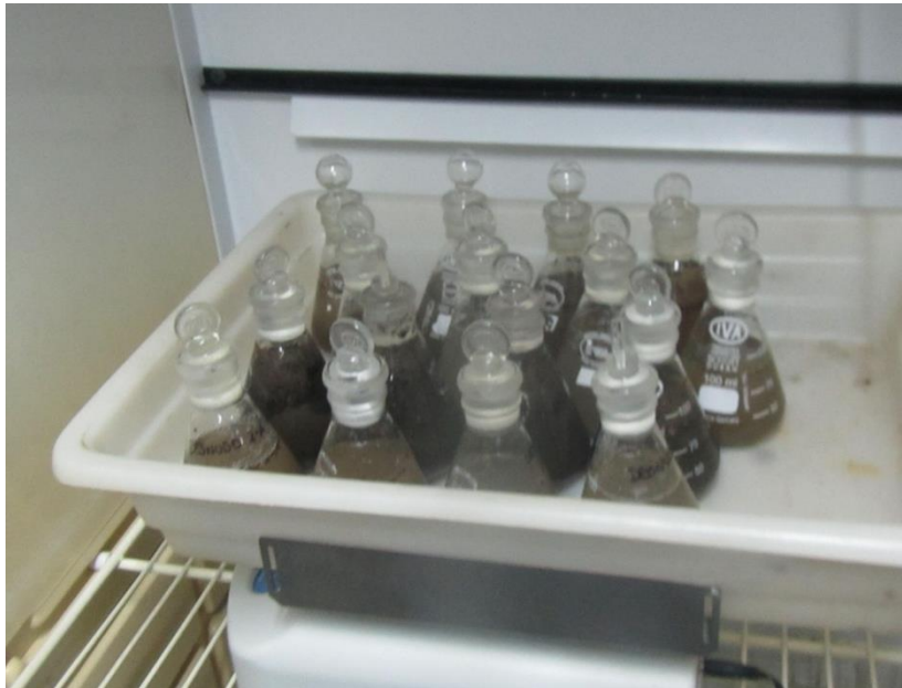
Figura 3. Preparación de lixiviados de suelos utilizando agitador orbital.
