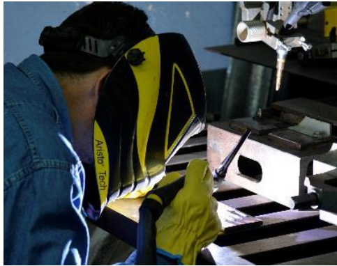
Figura 3.7. Realización soldadura GTAW.
