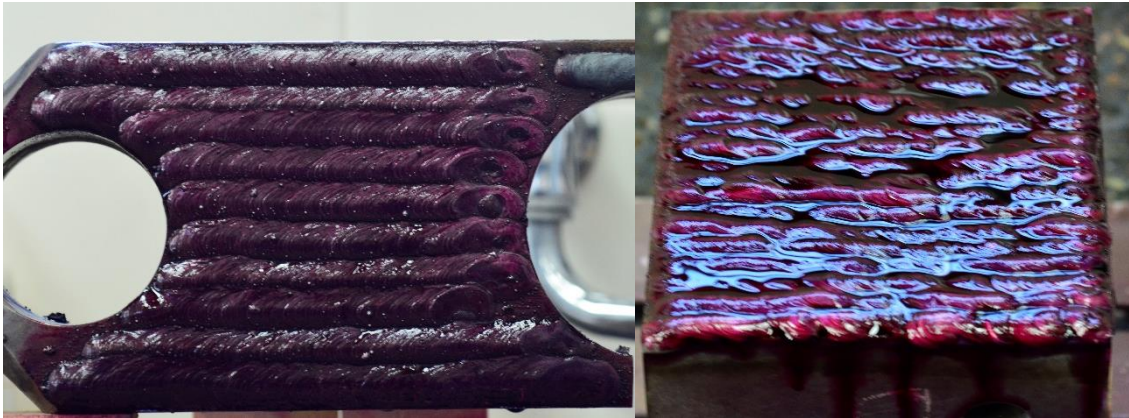
Figura 4.4. Ensayo de líquidos penetrantes.
