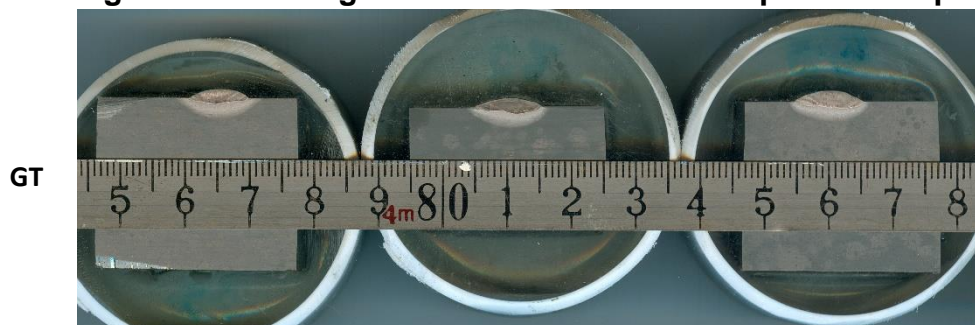
Figura 4.7. Macrografía de las soldaduras de pasada simple.
