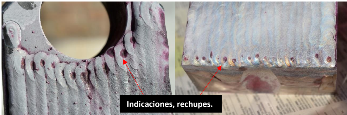
Figura 4.5. Indicación de defectos.
