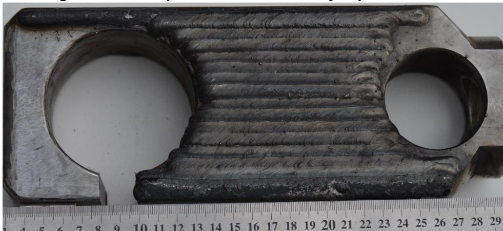
Figura 4.2.a. Cupón GMAW-C con bajo aporte térmico.
