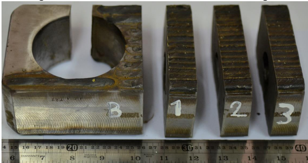
Figura 4.15. Macrografía del cupón soldado con GMAW-C.
