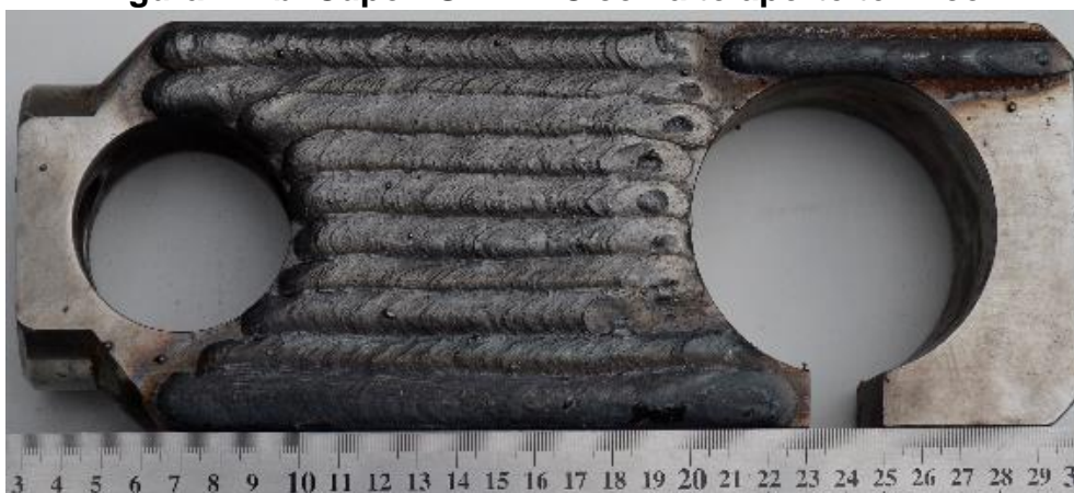
Figura 4.2.b. Cupón GMAW-C con alto aporte térmico.
