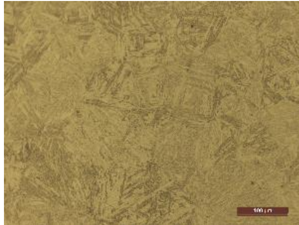
Figura 2.4. Recubrimiento duro superficial. a) Microscopio óptico. b) SEM. [2]
