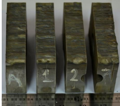
Figura 4.26. Macrografía del cupón soldado con GTAW.
