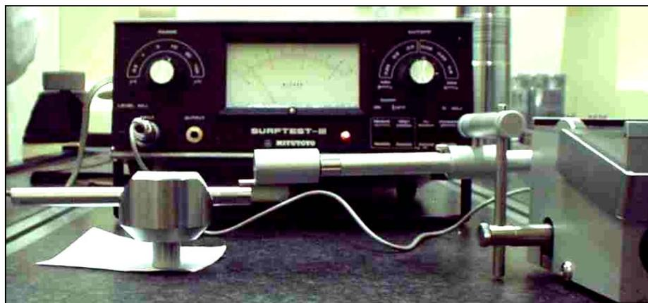
FIGURA 27 – Rugosímetro SURF TEST III de Mitutoyo con cabezal de doble efecto, sobre banco de mediciones.
