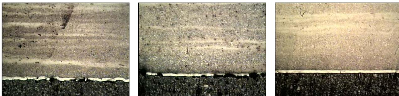
FIGURA 32 – Micrografías pertenecientes a las zonas A, B y C de la probeta 1A. Obsérvese claramente la diferencia entre los distintos tipos de rugosidades. Ataque Nitál x50.
