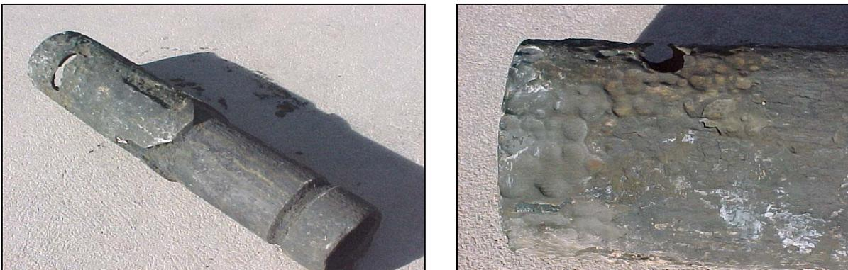
FIGURA 20 - Stinger localizador tipo J. Se observa corrosión severa en el exterior y un orificio de 70 x 15 mm en la parte superior. Tiempo desde la última intervención 2 años y 9 meses.
