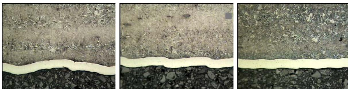
FIGURA 31 – Micrografías pertenecientes a las zonas A, B y C de la probeta 3B donde puede apreciarse la excelente adhesión entre la matriz y el niquelado. Ataque Nitál x200.
