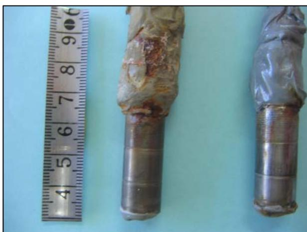
FIGURA 42 – Probetas 2A y 4B luego de los ensayos de RPL. Puede observarse claramente el cambio de color de los recubrimientos luego de la exposición al medio corrosivo.
