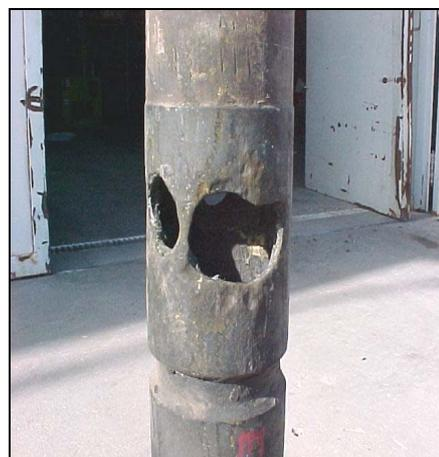
FIGURA 18 – Pácker permanente TWD. En la parte exterior se observa corrosión leve y 2 orificios de 60 x 35 mm. Tiempo desde la última intervención 2 años y 8 meses.
