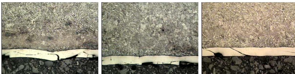
FIGURA 33 – Micrografías pertenecientes a las zonas A, B y C de la probeta 1A donde puede apreciarse la gran cantidad de fracturas producidas durante el corte en la preparación de las muestras. Ataque Nitál x200.
