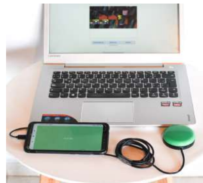
(b) Rol Pantalla en Notebook, Pulsador Virtual en Celular y Pulsador Físico conectado al Virtual.
