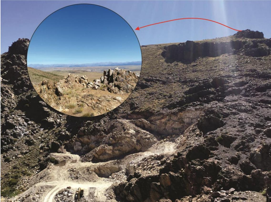
**Figura 17:** Vista hacia el N donde se observa el frente de explotación de la cantera mostrando en el detalle los crestones cuarzosos que conforman las unidades superiores.
