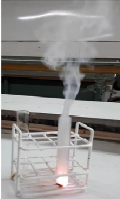
Figura 1.2. Reacción entre clorato de potasio fundido y azúcar.
