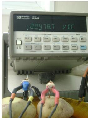
Figura 2.11. Lectura de potencial para dos papas conectadas en serie, utilizando electrodos de C/Cu.
