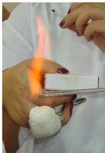
Figura 11.4. Reconocimiento de los iones sodio,  $\text{Na}^+$ , observándose el cambio de coloración de la llama.
