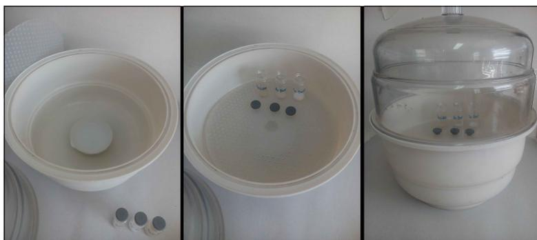
Figura 9.4. Armado del sistema para la adsorción de agua en desecador.
