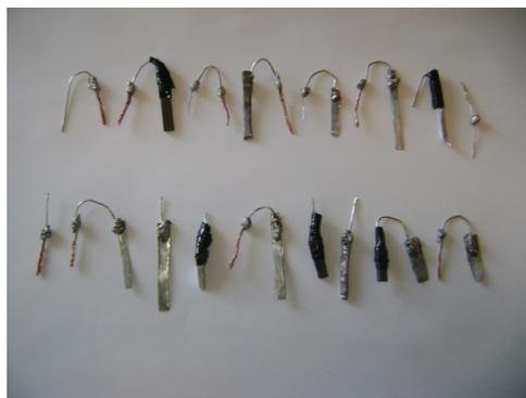
Figura 2.9. Electrodos preparados con diversos materiales.
