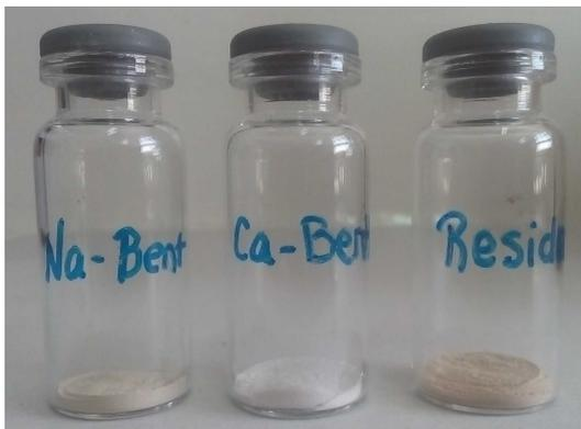
Figura 9.3. Muestras listas para adsorción de vapor de agua.
