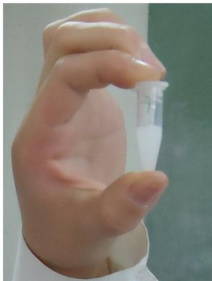
Figura 11.3. Reacción de reconocimiento de cloruros en tubo Eppendorf de 3 mL, observándose la formación de un precipitado de cloruro de plata.
