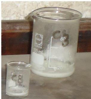
Figura 11.2. Secado del cloruro de sodio obtenido sobre plancha calefactora a microescala y a escala convencional.
