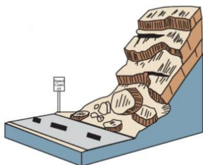
A. Caída y desprendimiento de rocas
