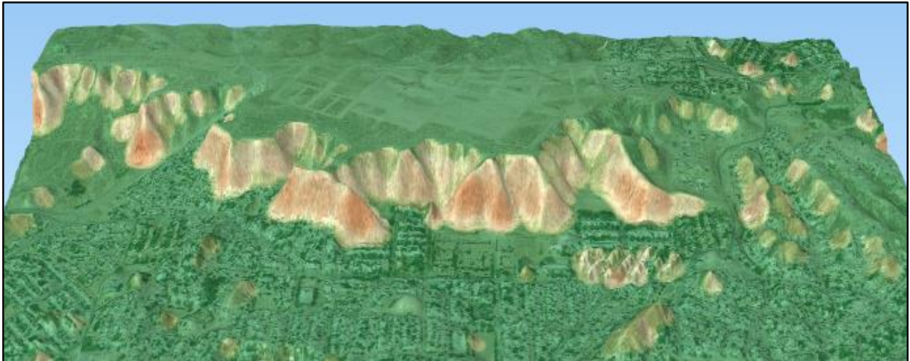
Figura 51: Representación de los resultados de la simulación con el software del USGS Scoops3D (escala vertical exagerada 3 veces). Variación del factor de seguridad (F) en el sector de estudio.
