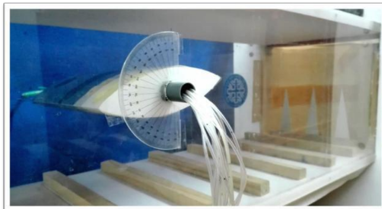
Figura. Modelo de techo dentro del túnel de viento
