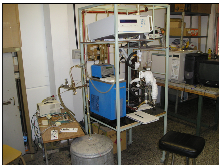
Figura 43. Sistema utilizado para contrastar el sensor de presión
