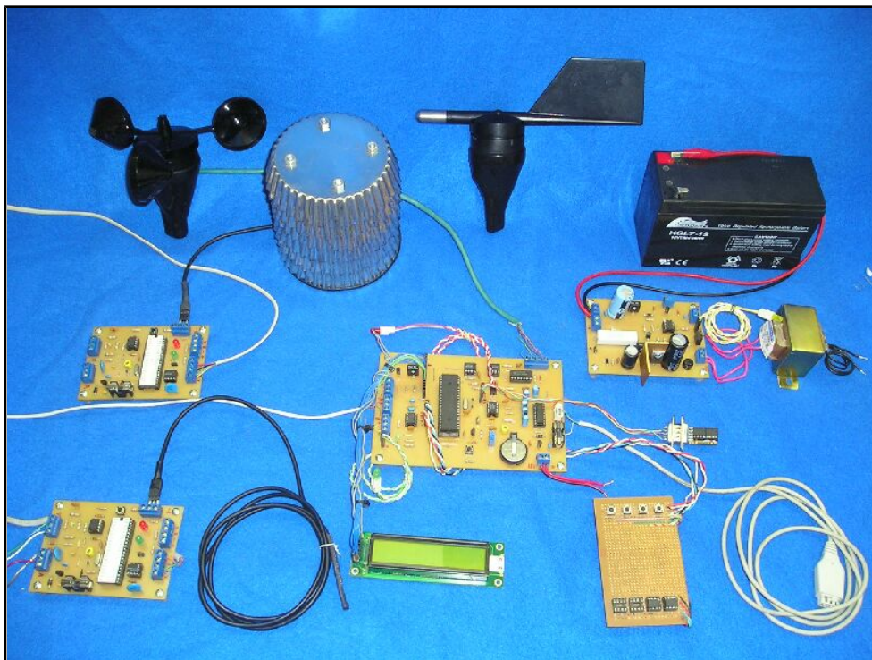
Figura 6. Placas de la estación anemométrica con los sensores, abrigo meteorológico y batería
