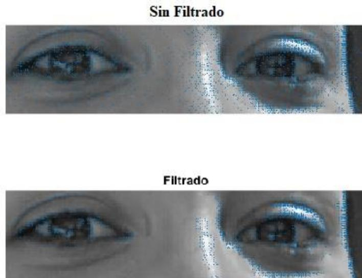
*Figura 23: Arriba, la imagen presenta un gradiente representado con pequeñas flechas azules. Abajo, solamente los gradientes que superan un umbral determinado son representados.*
