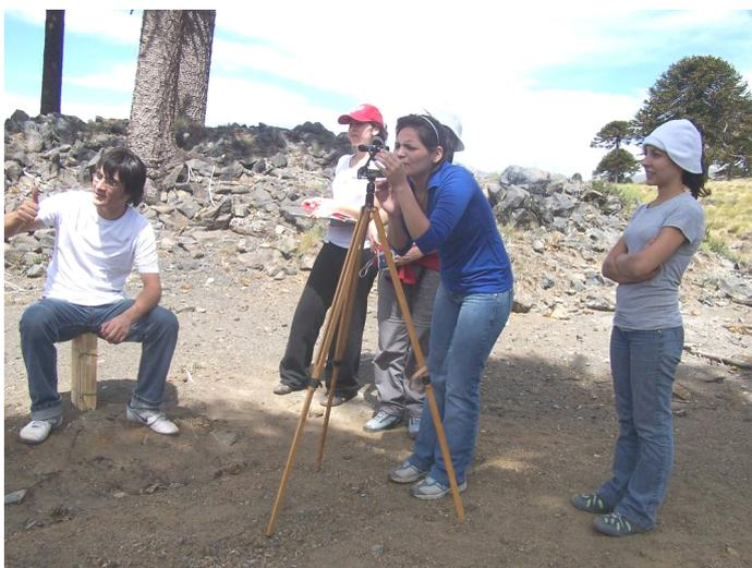
Fotografía N° 2. Alumnos realizando mediciones con un teodolito.
