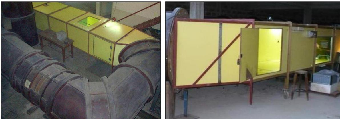
**Figura 3.4:** (a) Túnel de Viento, circuito cerrado. (b) Sección de prueba, puerta de acceso.
