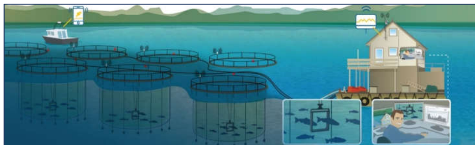
Figura 4.18. Marcos estáticos de haz de luz dentro de jaulas (transmiten la información a la estructura de superficie en forma inalámbrica) (Fuente VAKI S.A.)
