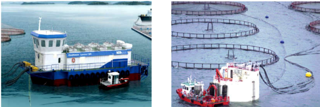
Figura 4.15 Balsas de alimentación con expendedores de aire comprimido
