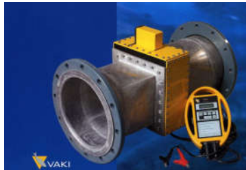
Figura 4.17. Contador de peces por bombeo eléctrico para ser montado en tuberías (diámetro 8”-14”); rango tamaño 0.3 Kg-10 Kg; capacidad 40 ton/h). Fuente: Vaki S. A.
