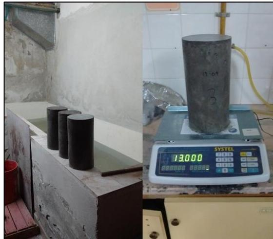
Figura 6-5 Probetas pasados los 28 días
