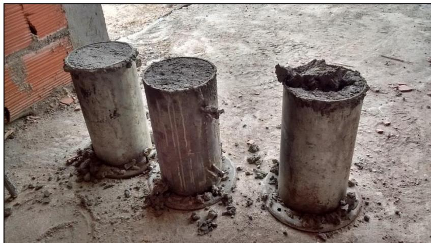
Figura 6-3 Probetas realizadas en obra
