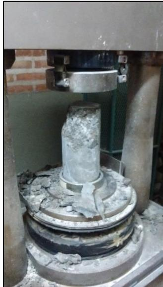
Figura 6-7 Rotura probeta N°3
