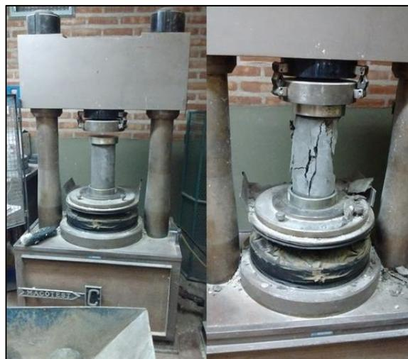
Figura 6-6 Rotura a compresión
