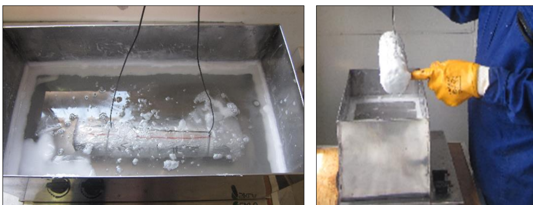
Figura 36: Izquierda: Testigo sumergido en baño termostático de parafina. Derecha: Testigo con capa de parafina. Referencia: Christensen Roder.
