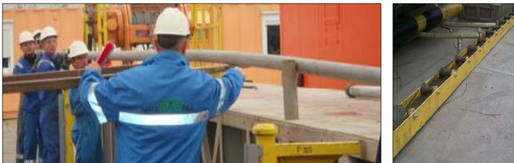
Figura 35: Izquierda: Testigo flexionado por procedimiento inapropiado; Derecha: Core cradle: Porta testigo. Referencia: Productos y servicios Christensen Roder.
