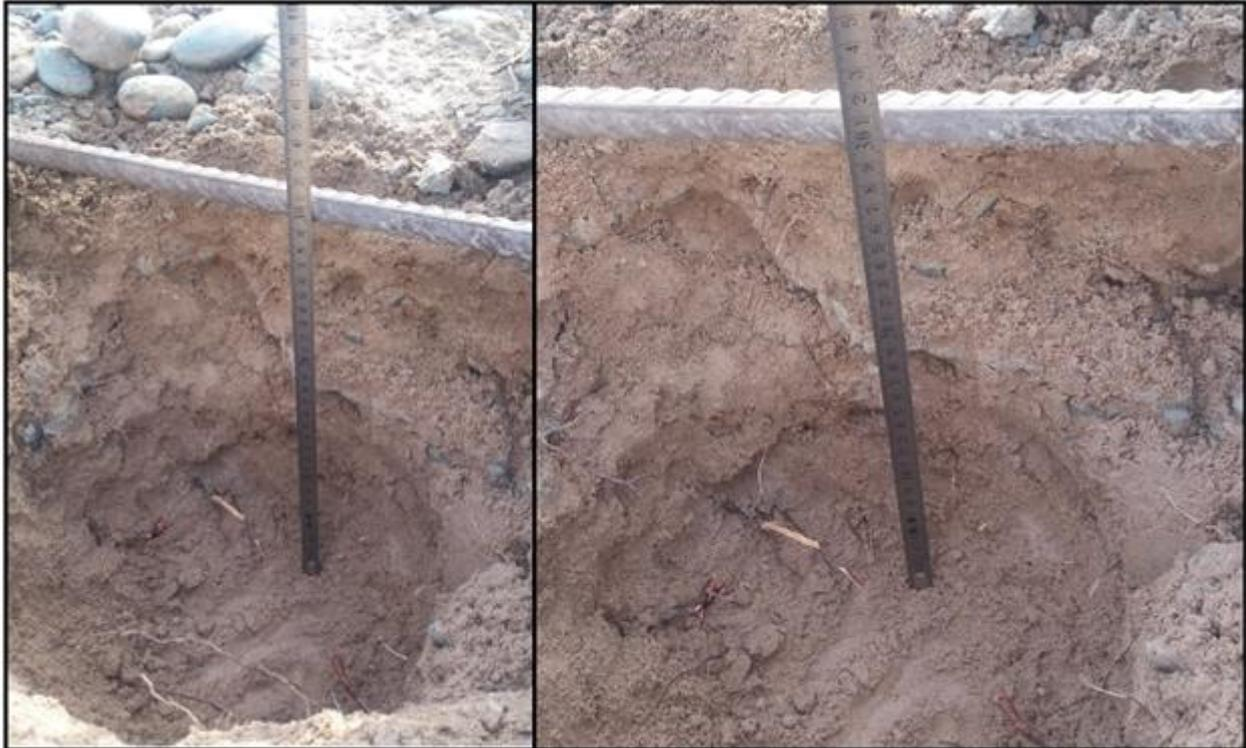
Figura 5.8 – Excavaciones realizadas para hallar el manto de roca resistente
