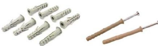
Fijaciones Pesadas (por sobre 30kg) → Para grandes armarios y objetos muy pesados el procedimiento habitual es amurar anclajes de acero o tarugos/clavo de al menos 8mm directo al hormigón.
