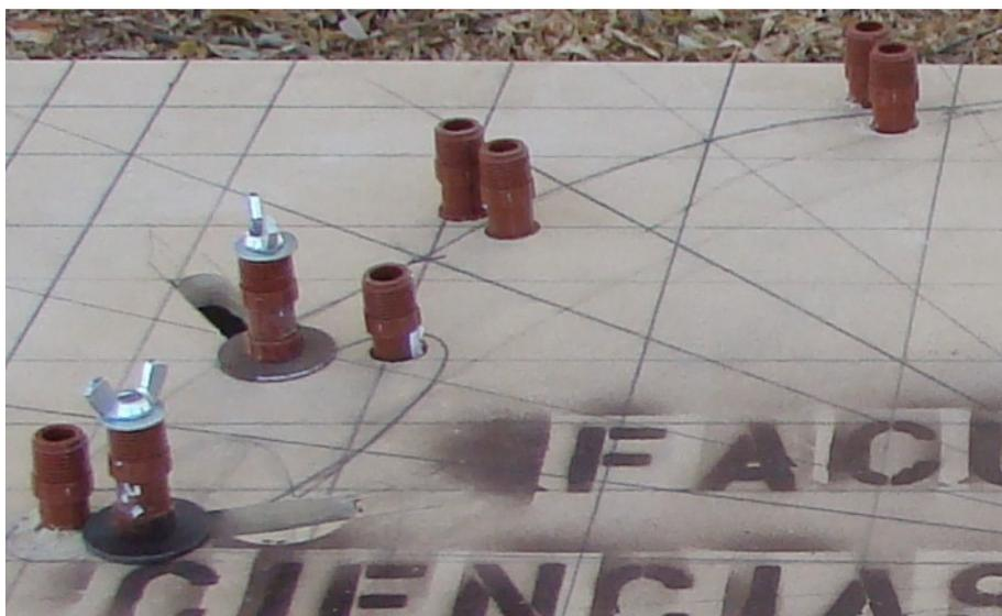
Luego a la altura del contorno de las “orejas” se confeccionaran 2 guías tipo corredera por cada lado, donde se puedan trasladar los tornillos para abrir y cerrar el paso del alambroón del arco, como se muestra en la foto.
