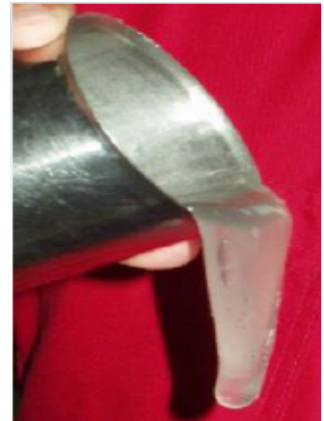
Figura 5. 5: Prueba de formación de lengua para un gel entrecruzado
