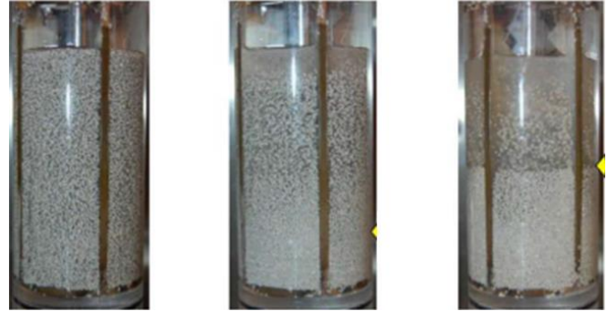
Figura 5. 11: Ensayo de transporte de agente sostén dinámico (Fuente SPE 191831)
