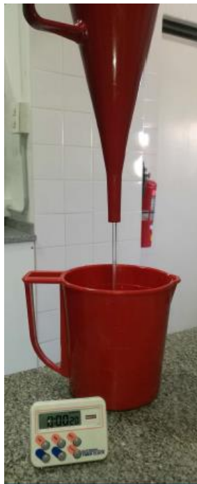
Figura 5. 1: Embudo de Marsh para medición de la viscosidad
