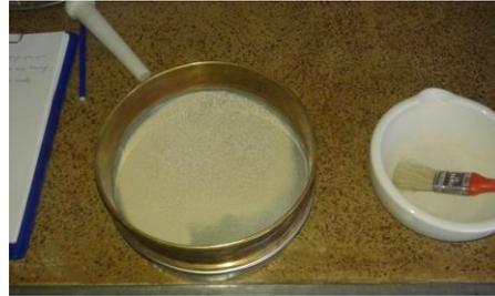
Figura 12. (Izquierda). Mortero de agata. Figura 13. (Derecha). Tamiz malla #200, (74 micrones, 0.0737 mm).
