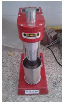
Figura 16. Viscosímetro rotativo Fann.
