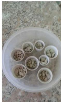
Figura 14. Crisoles de cerámica con bentonita
