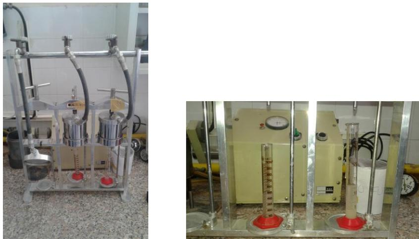
Figura 17. (Izquierda). Estructura del prensa-filtro. (Derecha). Recolección del volumen de filtrado.
