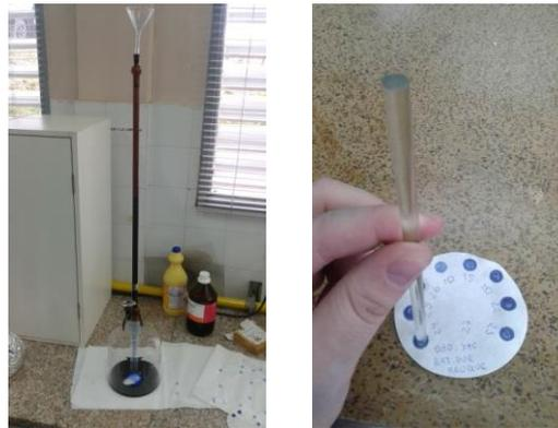
Figura 19. (Izquierda). Bureta de 100 ml enrasada con “azul de metileno”. (Derecha). Método de trabajo donde se identifica el halo de dispersión
