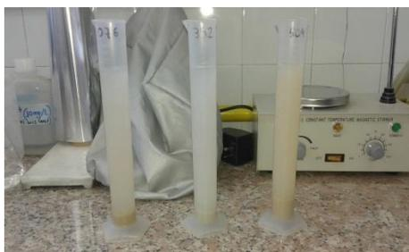
Figura 18. Probetas calibradas, lectura del hinchamiento volumétrico.
