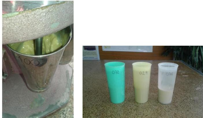
Figura 15. (Izquierda). Mezcladora con el vaso metálico rotulado. (Derecha). Bentonita en reposo.
