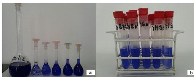
Figura 4. 16- a- Solución patrón de Cu-TEA para la curva de calibración, b-muestras de fangos con el reactivo.
