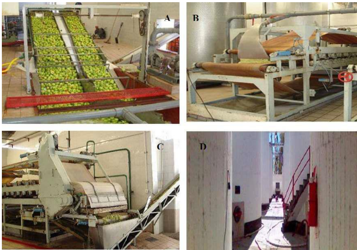
Figura 3: Equipamiento utilizado en la elaboración de sidras patagónicas. A: Cinta transportadora. B: Prensa de cintas. C: Descarte del orujo. D: Sector de las piletas de fermentación.
